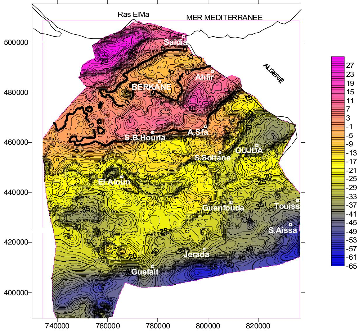
Fig.2 Carte d'anomalie de Bouguer (densité de correction :  $2.2 \text{ g/cm}^3$ , intervalle=1mgal).
