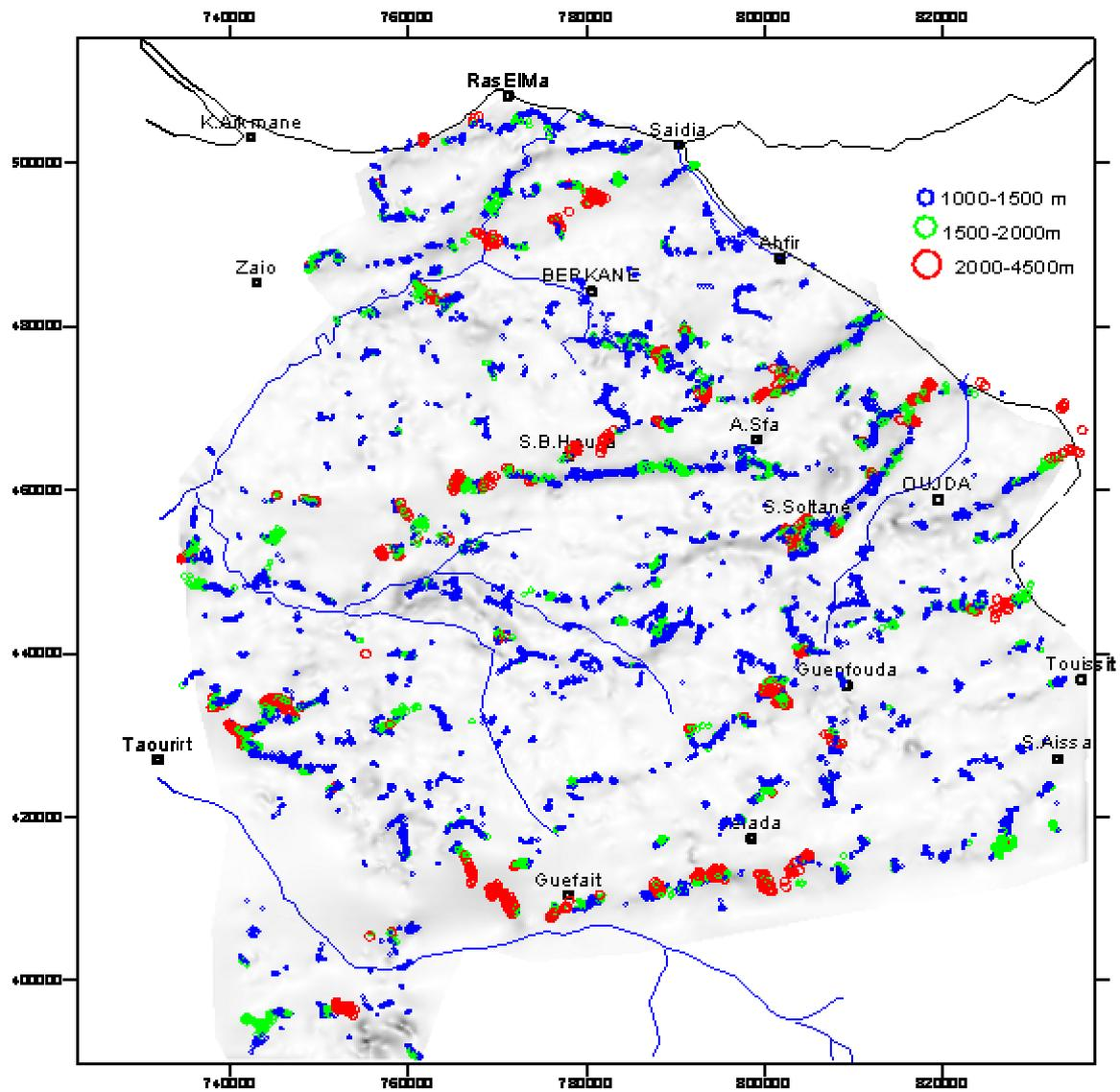
Fig.5 Carte des solutions d'Euler ayant une profondeur supérieure à 1 km pour l'indice structural  $IS = 0.25$ , une fenêtre de  $10 \times 10$  ( $2250 \times 2250$  m) et une erreur relative maximale de 15%.
