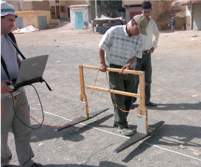
Photo 2. Levé du radar géologique à l'aide d'un équipement Ramac.
