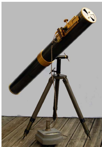
Pyrhéliomètre Féry-Millochau (Charles Beaudouin constructeur).
