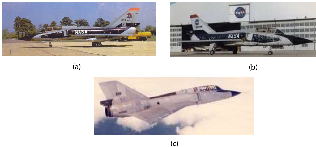
FIGURE 6. Images du F106B utilisée par la NASA pour les campagnes en vol sur l'étude du foudrolement de 1980 à 1984. (a) Image avant les campagnes en vol (Source NASA). (b) Image après un certain nombre de foudrolements (Source NASA). (c) Image du F106B après le retrait de sa peinture (Source NASA).
