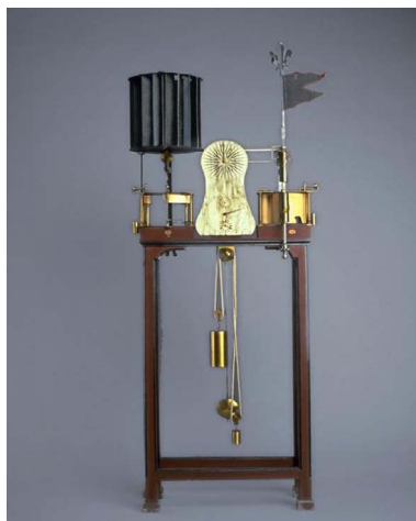
Anémomètre de Pajot d'Ons-en-Bray (1734). Capable d'enregistrer durant 30 heures force, direction et durée du vent.
